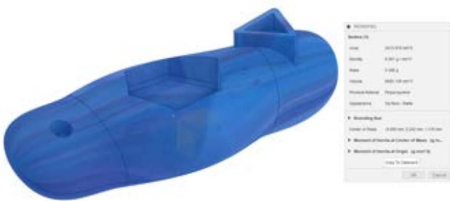
La masse du plastique utilisé pour l'injection, canaux d'injection inclus, doit être supérieure à la masse de l'objet à injecter.
