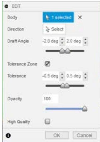
L'angle de dépouille minimum recommandé est de 2°, mais pour des moules sécurisés, nous conseillons 4°. Les surfaces sans angle de démoulage sont mises en évidence en rouge, indiquant que le démoulage est impossible.
